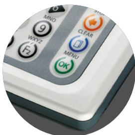
Leicht zu reinigende Folientastatur mit Druckpunkt
